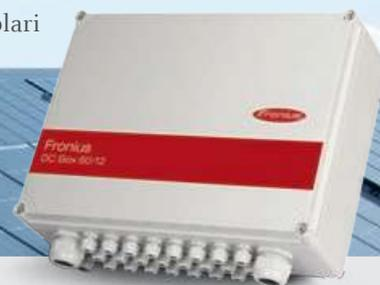
/ Fronius DC Box 60/12 consente di raggruppare fino a 12 stringhe di moduli solari con una corrente totale massima di 60 ampere. In aggiunta alla funzione di raggruppamento delle stringhe, la protezione del campo di moduli solari è assicurata dai fusibili. Fronius DC Box 60/12 consente inoltre di montare un componente per la protezione contro le sovratensioni esterno su guida DIN secondo il tipo 1 o il tipo 2.
